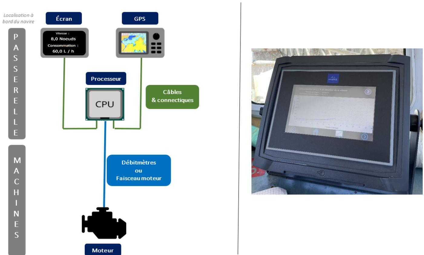
Figure 1 : (partie gauche) Schéma d'installation d'un outil de mesure analytique ; (partie droite) photo d'un économètre analytique AMARREE
