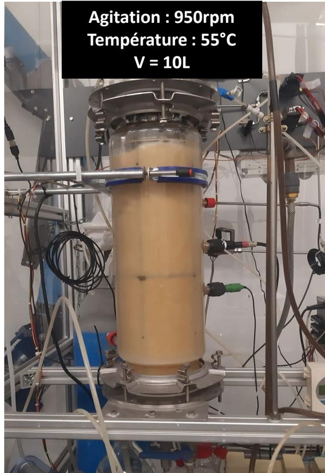
1. Trois différents sources de nutriments sont testées dans un pilote en colonne agitée en continu :
