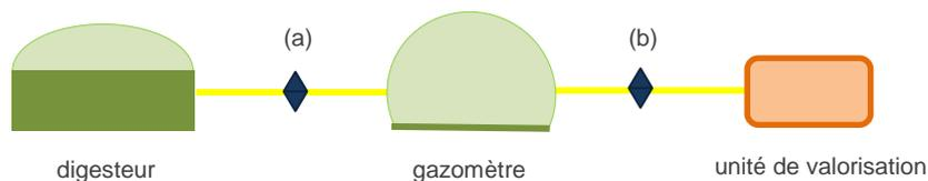
Dans cette configuration d'unité on peut envisager deux emplacements pour positionner les débitmètres en fonction de l'exploitation souhaitée de la mesure.
