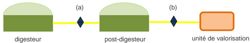
Sur beaucoup d'installations, un post-digesteur est associé au digesteur primaire. Il permet de poursuivre la dégradation de la matière organique et ainsi obtenir une production conforme aux prévisions. La plupart du temps, il fait office de gazomètre et permet également le stockage du digestat.
