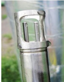
Exemple de condensation et de formation de gouttelettes sur une sonde de mesure.
