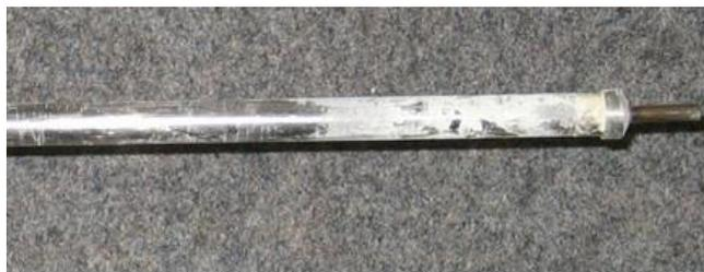
Exemple d'encrassement d'une sonde de mesure.
