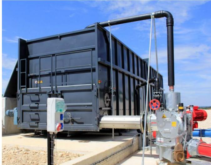
Figure 3: Ensemble VIELFRASS SB (caisson à fond mouvant) et broyeur en ligne PREMIX
