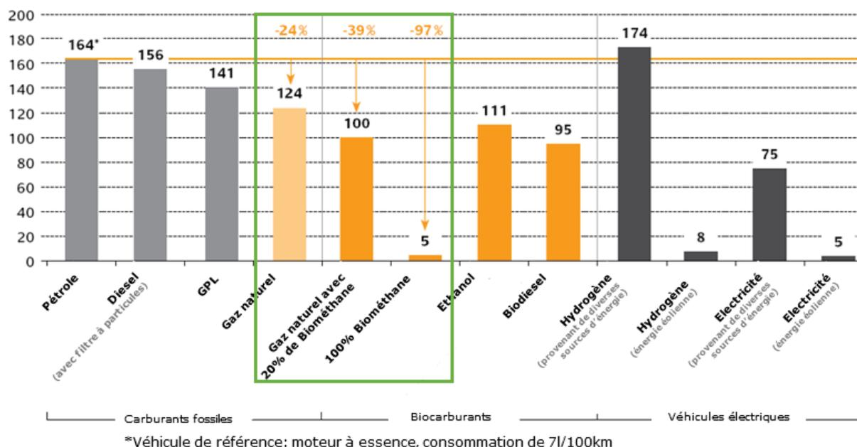
**Figure 2 : Émissions de GES du puits à la roue en gramme de CO<sub>2</sub>/km pour différents carburants**
