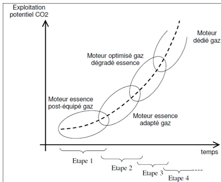
**Figure 3** : Lien entre l'évolution des technologies moteur et les émissions de CO<sub>2</sub> pour les véhicules au gaz naturel.
