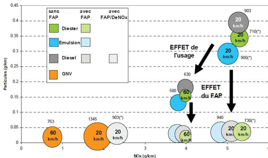
**Figure 1 : Comparaison des émissions de particules, de NOx et de gaz à effet de serre (GES) du puits à la roue (surface des disques) des filières poids lourds 19 tonnes avec ou sans filtres à particules (FAP)**
