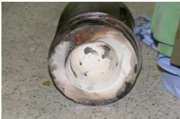
Figure 2: Colmatage d'un piston d'un moteur à gaz
