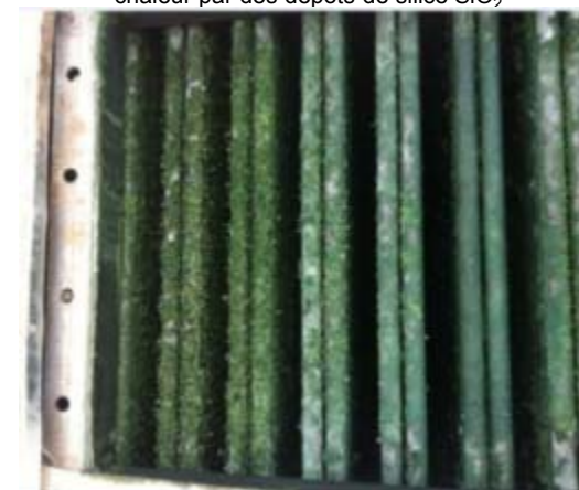
Figure 6 : Dépôt de sulfate ferrique hydraté ( \text{Fe}_2(\text{SO}_4)_3 \cdot x \text{H}_2\text{O} ) sur l'échangeur fumée
