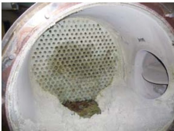
Figure 4: Echangeur endommagé par des résidus de siloxanes
